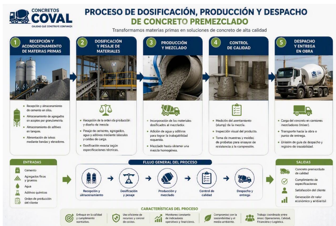
Ilustración 4. Proceso de dosificación, producción y despacho de concreto premezclado en Concretos Coval. Fuente: Elaboración propia.
