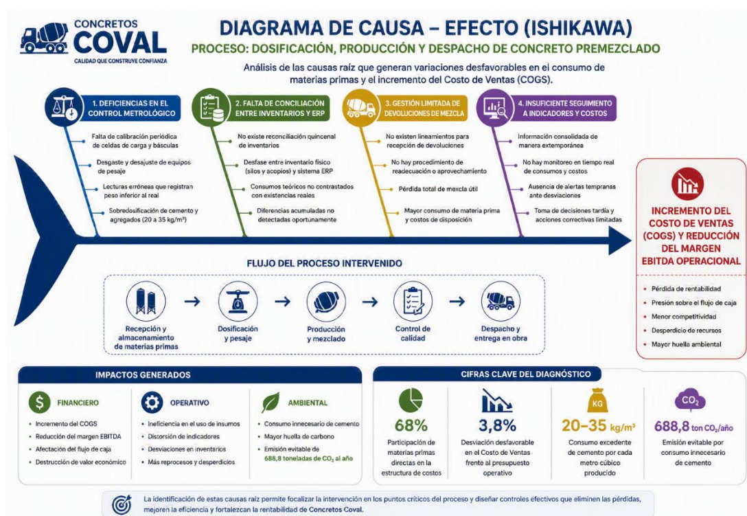
Ilustración 5. Diagrama de causa-efecto (Ishikawa) del proceso de dosificación, producción y despacho de concreto premezclado. Fuente: Elaboración propia.
